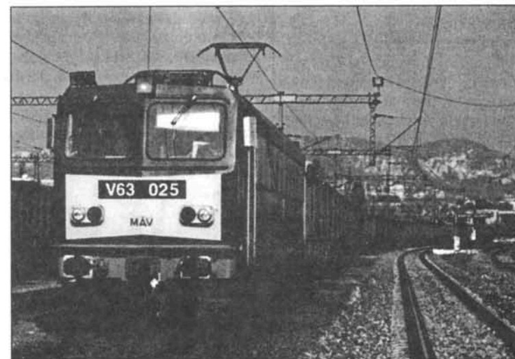
Elektrolokomotivo de MÁV tipo V63 funkcia per tiristoro.
